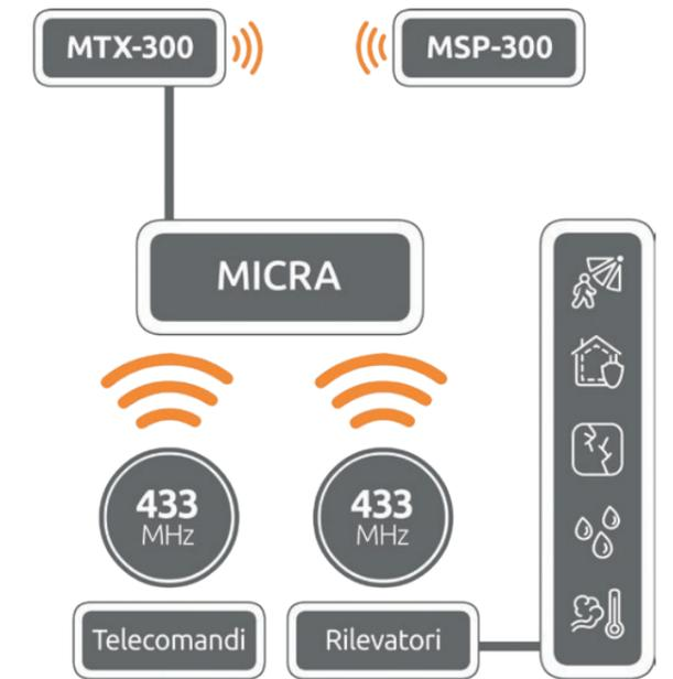
MTX-300 può anche essere collegato al modulo MICRA per estendere la sua funzionalità aggiungendo il controllo delle sirene senza fili MSP-300. Gli ingressi filari della MICRA possono essere utilizzati per ricevere segnali da ulteriori rilevatori wireless. Come risultato, l'aggiunta di MTX-300 permette di utilizzare fino a 12 rilevatori senza fili nel sistema o di espanderlo con l'aggiunta di ulteriori telecomandi.
