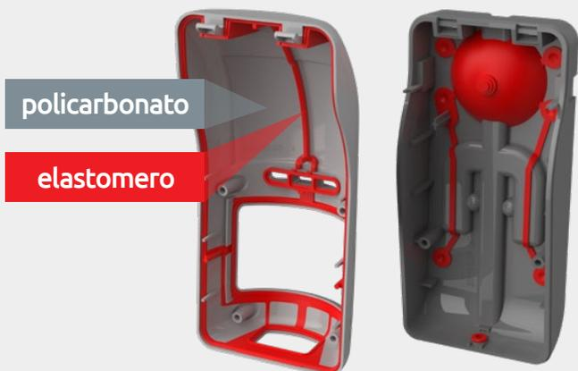
Per la produzione delle cover dei rilevatori OPAL, è utilizzata la tecnologia **a iniezione bi-componente**. Grazie alla combinazione di polycarbonato ed elastomero termoplastico, è stato riconosciuto il grado di **protezione IP54**. Questa custodia protegge l'elettronica contro agenti atmosferici quali pioggia, neve, nebbia o umidità. I rilevatori OPAL sono caratterizzati da elevata resistenza meccanica e ai raggi UV, in modo da mantenere l'aspetto esterno invariato per anni.
