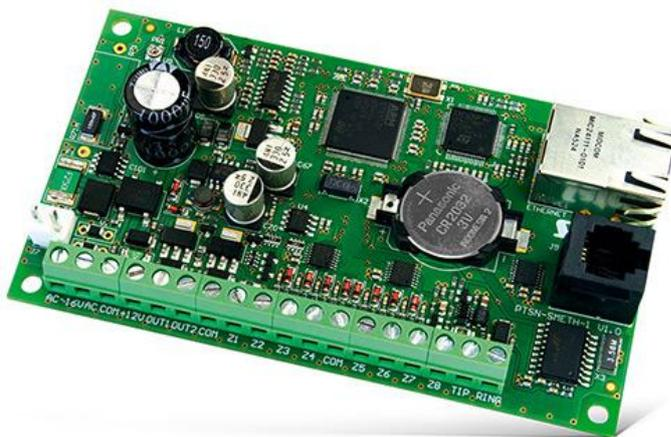
El módulo ETHM-2 puede configurarse remotamente por medio de la red Ethernet o localmente a través del puerto RS-232 con el uso del ordenador PC con el software **ETHM-2 Soft** instalado. El control remoto del módulo es posible también por medio del navegador WWW (se refiere sólo al ETHM-2 FLASH v1.02).
