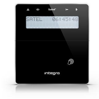
Su fuente de alimentación son dos pilas CR123A 3 V. El estado de las pilas se está continuamente controlando. El dispositivo funciona en modo activo y en modo de espera (ahorro de energía al cabo de 20 segundos de inactividad). Para ahorrar más energía es posible desactivar el lector de tarjetas de proximidad (por ejemplo, en caso de que el sistema de alarma no va a controlarse a través de ellas).
